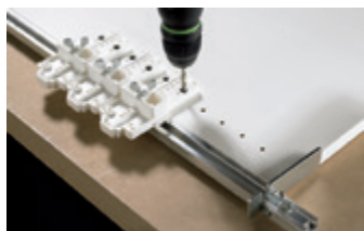
穴開け治具 ▶ ヒンジと座金用 ▶ レール、ジョイント金具、ハンドル用 商品ラインナップ / 仕様説明
