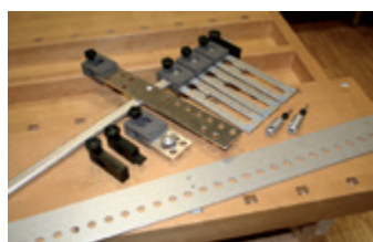
さまざまなテンプレート付きのAccura穴開け治具 多様なアプリケーションに対応する実用的なモジュラーシステム
