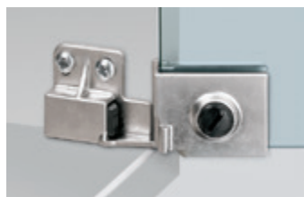
厚さ6.5mmまでのガラスに対応可能なガラス扉用ヒンジ 穴加工なし
